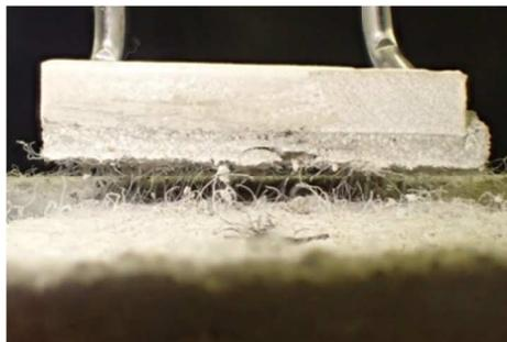
写真6 せん断接着試験後のタイルを持ち上げた状況
