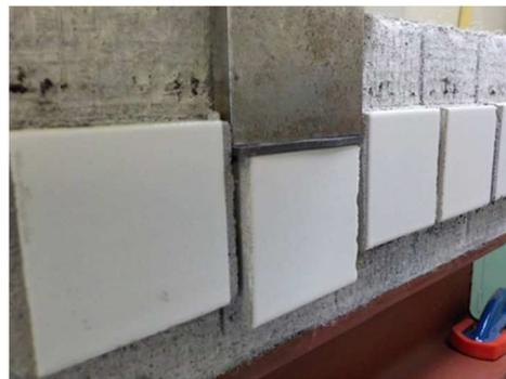
写真5 繰り返し軸ひずみ追従試験(36,500回)後のせん断接着試験の状況
