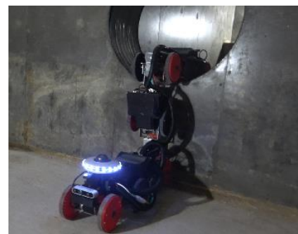
自律走行ヘビ型ロボットの人通口通過
