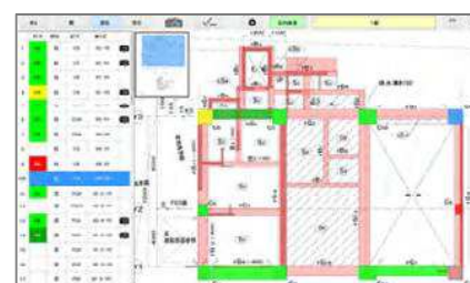
▲部位ごとの検査状況を確認
