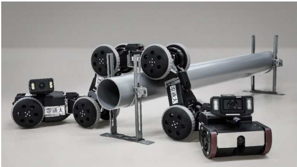
共同開発した床下点検ヘビ型ロボット「ユカダイショウ™」／写真提供：電気通信大学 田中基康研究室
